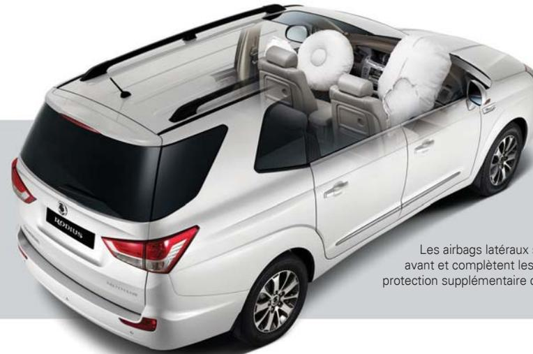
Les airbags latéraux sont de série pour la rangée avant et complètent les airbags frontaux pour une protection supplémentaire contre les chocs latéraux.
