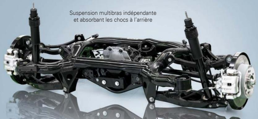
Suspension multibras indépendante et absorbant les chocs à l'arrière
